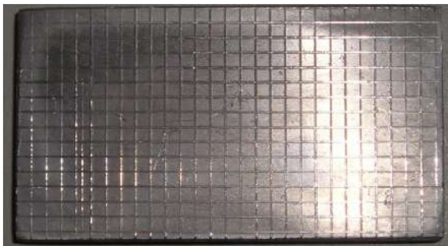
Rys. 4. Próbką z siatką koordynacyjną do wyciskania współbieżnego w płaskim stanie odkształcenia
