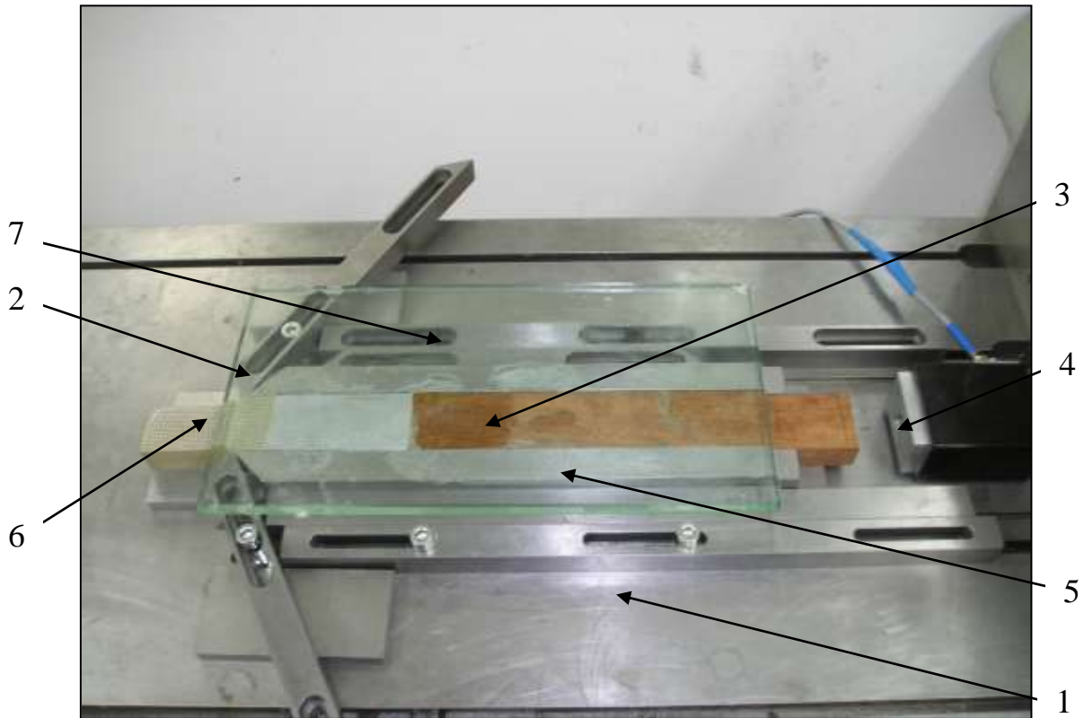
Rys. 3. Widok stanowiska do modelowania fizycznego procesu wyciskania współbieżnego w płaskim stanie odkształcenia
